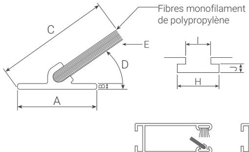
Fibres monofilament de polypropylène
