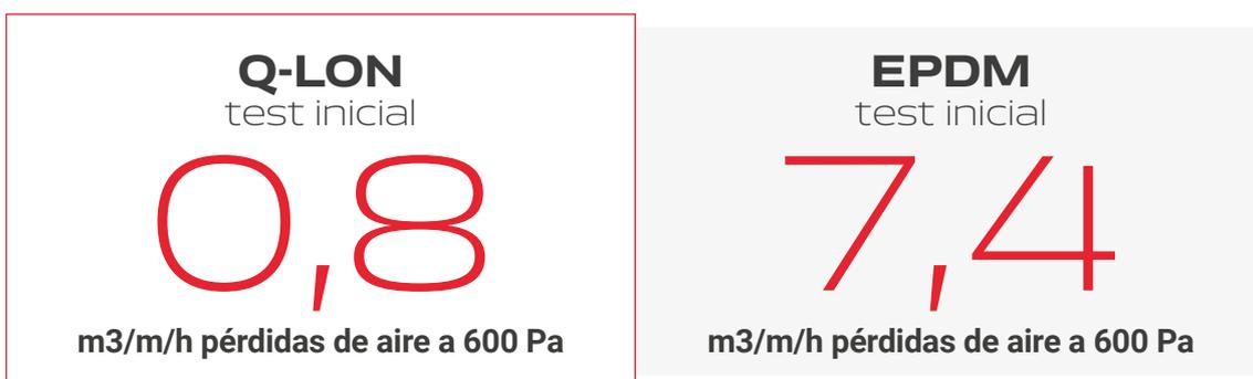
Q-LON ha demostrado prestaciones notablemente mejores en términos de permeabilidad al aire durante el test inicial, sin dejar de garantizar una estanqueidad eficaz incluso después de 10.000 ciclos completos de accionamiento de la ventana. **La variación de las prestaciones después del test repetido fue de sólo el 2,33%.**
