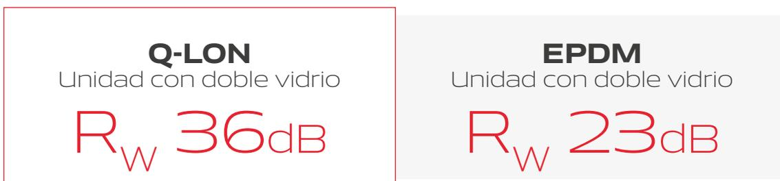
El índice de evaluación del poder fonoaislante ( $R_w$ ) mide la eficacia de un material de insonorización. El incremento del valor  $R_w$  en un punto equivale a 1 dB de reducción del ruido.
