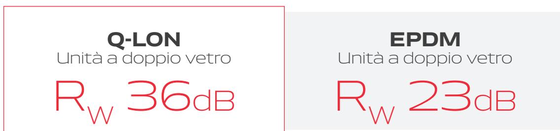
L'indice di valutazione del potere fonoisolante ( $R_w$ ) valuta l'efficacia di un materiale di insonorizzazione. L'incremento del valore  $R_w$  di un punto equivale a 1 dB di riduzione del rumore. **Le finestre dotate di Q-LON si sono dimostrate in grado di abbattere il rumore esterno di 13 decibel se confrontate alle guarnizioni EPDM montate sulla stessa finestra.**
