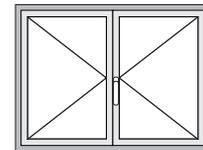
Konfiguration Doppelflügel CHIC 100 mit Standardprofilen (zweiseitig wirkend)
