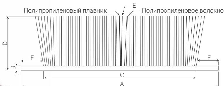
Мягкое многофиламентное волокно, обработанное силиконом, на тканой прозрачной основе с усилением. Доступен в отрезках по размеру и в бобины для узкого и более широкого применения в качестве уплотняющих решений для раздвижных дверей или мебели. Дополнительная клейкая основа, плавники и моноволоконные кромки.
