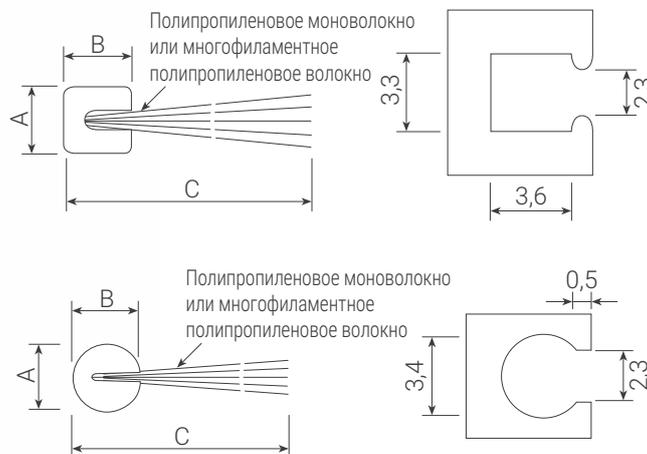
Экструдированное квадратное или круглое основание для уплотнения зазоров по краям вращающихся дверей, роликовых ставней и других узкопрофильных применений. Более жесткое 6-слойное моноволокно без обработки или более мягкое стандартного многофиламентное волокно, обработанное силиконом. Основания другой формы и размеров доступны по запросу.
