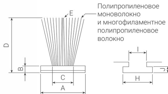
Тканое волокно на прозрачной основе. Мягкое многофиламентное волокно, обработанное силиконом, частично усиленное с помощью более жесткого моноволоконно без обработки. Обычно оно вставляется в Т-образные пазы боковых направляющих каналов для уплотнения роликовых ставней и аналогичных изделий. Дополнительная клейкая основа.
