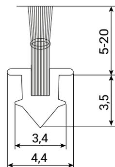
Щётка с обработанным силиконом (от намокания) мягким ворсом на экструдированном основании, разработанном для установки в паз в дереве. Лёгкая установка и надёжная фиксация.
