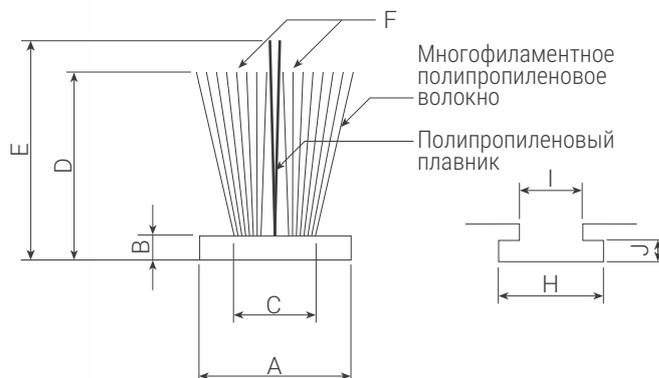
Мягкое многофиламентное волокно, обработанное силиконом, на тканой прозрачной основе с усилением. Спаянный прозрачный центральный плавник для улучшенного внешнего уплотнения раздвижных окон и дверей. Дополнительная клейкая основа.
