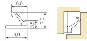
Уплотняемый зазор: 3,5 - 6,0
