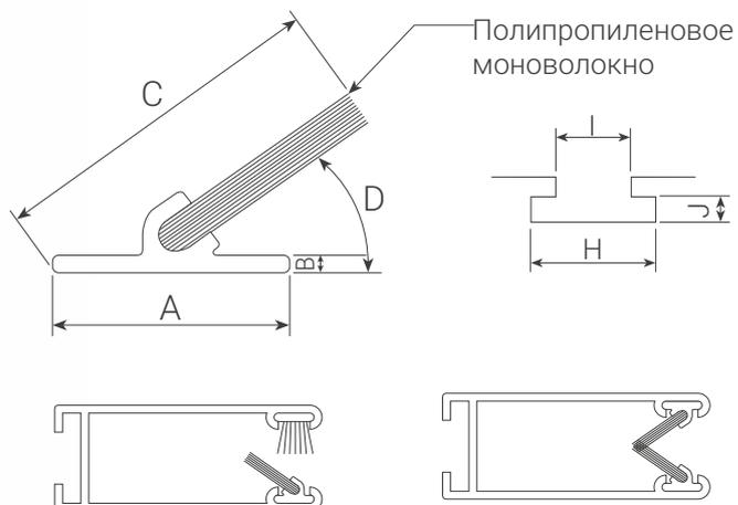
Обработанное силиконом волокно с экструдированным основанием. Доступны варианты расположения под углом 35°, 45° или 60°. Оптимален для центральной щетки, подходит для машинной установки. В основном применяется в боковых направляющих каналах для роллет с москитной сеткой. Может быть установлен с одной стороны вместе с более мягкой стандартной щеткой или с двух сторон для удержания сетки в направляющих.
