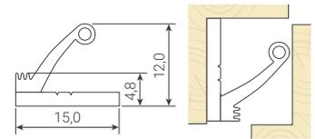
Уплотняемый зазор: 5,0 - 11,0
