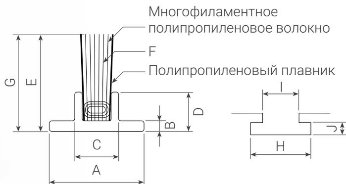
Мягкая щетка из обработанного многофиламентного волокна на экструдированном основании с вертикальными направляющими. Оптимально для центральной щетки, хорошо подходит для машинной установки.
