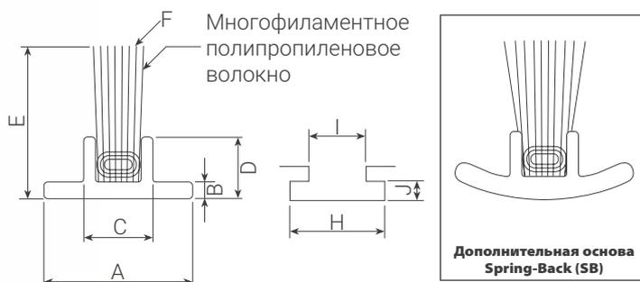
Мягкая щетка из обработанного многофиламентного волокна на экструдированном основании с вертикальными направляющими. Оптимально для центральной щетки, хорошо подходит для машинной установки. Дополнительная клейкая основа.
