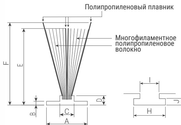
Мягкое многофиламентное волокно, обработанное силиконом, на экструдированном основании. Оптимально для центральной щетки, хорошо подходит для машинной установки.
