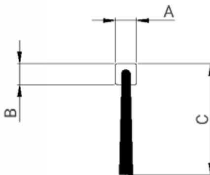
Щётка с экструдированным квадратным основанием для использования во вращающихся дверях, в эскалаторах, гаражных дверях и промышленных воротах.
