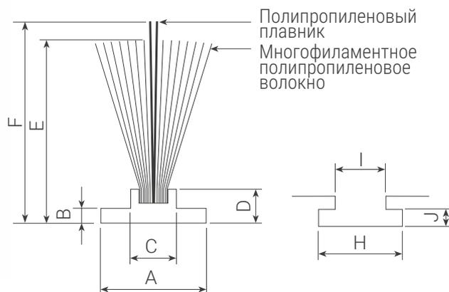
Мягкое многофиламентное волокно, обработанное силиконом, на экструдированном основании. Оптимально для центральной щетки, хорошо подходит для машинной установки.
