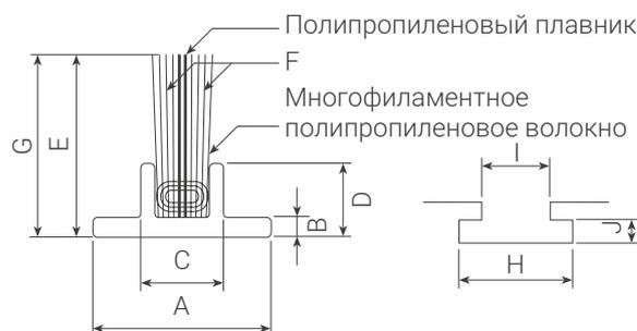
Мягкая щетка из обработанного многофиламентного волокна на экструдированном основании с вертикальными направляющими. Оптимален для центральной щетки, хорошо подходит для прозрачного центрального плавника машинной установки благодаря тому, что щетка сохраняет оптимальный внешний вид, обеспечивая при этом улучшенную герметизацию для сдвижных окон и дверей. Дополнительная клейкая основа.
