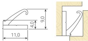
Уплотняемый зазор: 4,0 - 8,0
