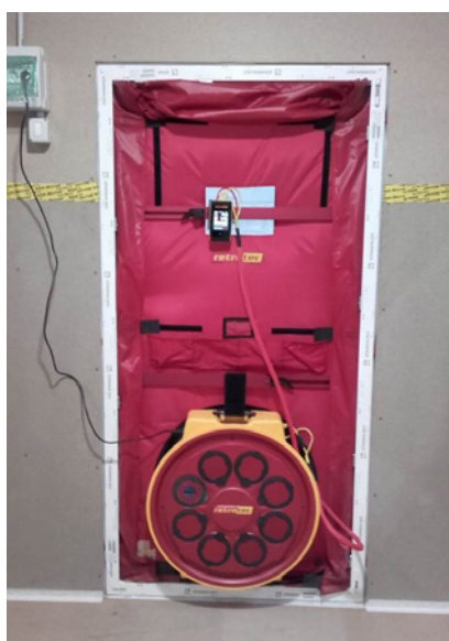
Figura 9.6. Ensayo de puerta soplante
