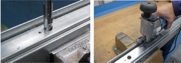
Figura 6.10.1. Mecanizado con ayuda de útiles
