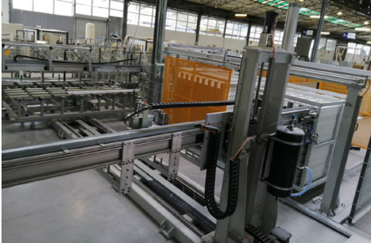
Figura 6.1. Centro de corte y mecanizado
