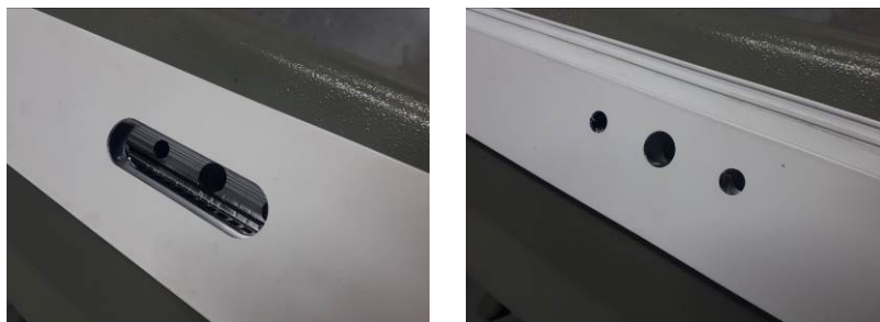
Figura 6.5. Perfil mecanizado para incorporación de maneta
