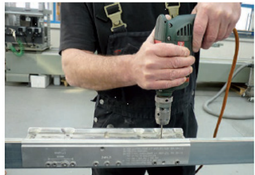
Figura 6.10.1. Mecanizado con ayuda de útiles
