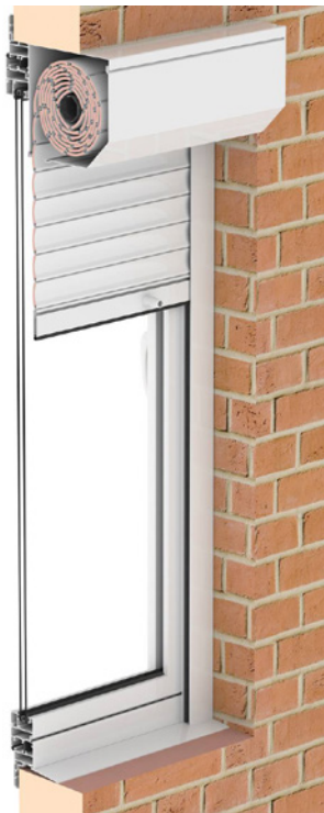
Figura 4.36. Detalle cajón de persiana por el exterior
