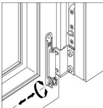
Regulación lateral soporte esquina inferior
