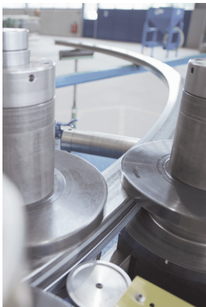
Figura 6.19. Sistema de rodillo para curvado de perfiles de acero
