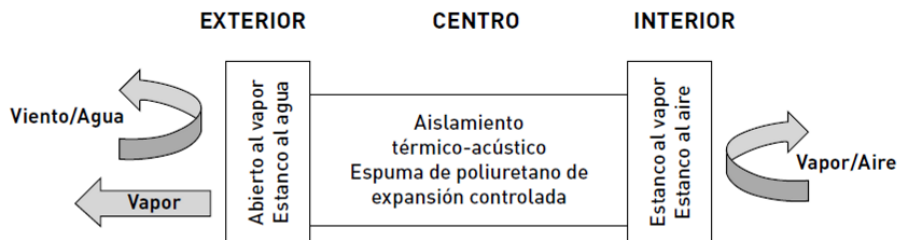
Figura 9.3. Esquema de sellado y aislamiento de la junta
