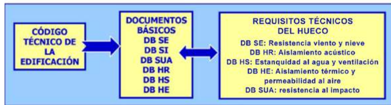
Figura 2. Prestaciones del hueco
