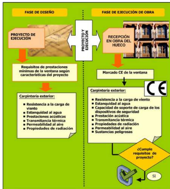
Figura 3. Marcado CE y CTE en huecos
