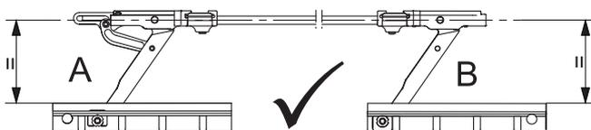
Parallelismo anta-telaio tramite bracci
