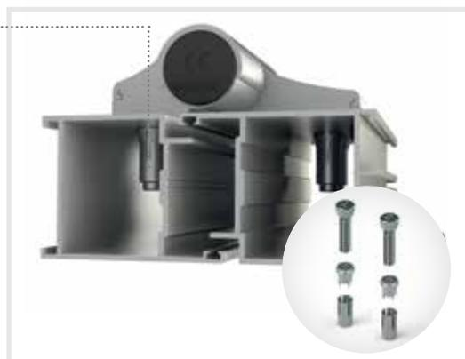
Les deux systèmes de fixation rapide (vis M12 et vis) représentent la solution idéale pour remplacer et/ou ajouter des paumelles sur d'anciennes menuiseries car ils s'adaptent aux portes déjà installées et aux dormants à périmètre fermé. Ils n'entraînent aucune intervention sur le profil, à part un orifice standard de 11 mm réalisable à l'aide des gabarits prévus à cet effet.
